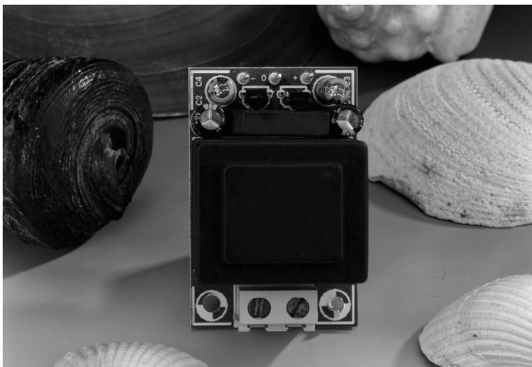
Gerade bei kleinen Audio-(Zusatz-)Schaltungen wie Mikrofonvorverstärkern, Zwischenverstärkern und Impedanzwandlern benötigt man häufig eine symmetrische Stromversorgung, die nur ein paar Milliampere zu liefern braucht. Das hier gezeigte kleine symmetrische Netzteil ist in diesen Fällen genau das richtige. Bei einer Ausgangsspannung von  $\pm 15\text{ V}$  liefert es einen Strom von 25 mA, der
